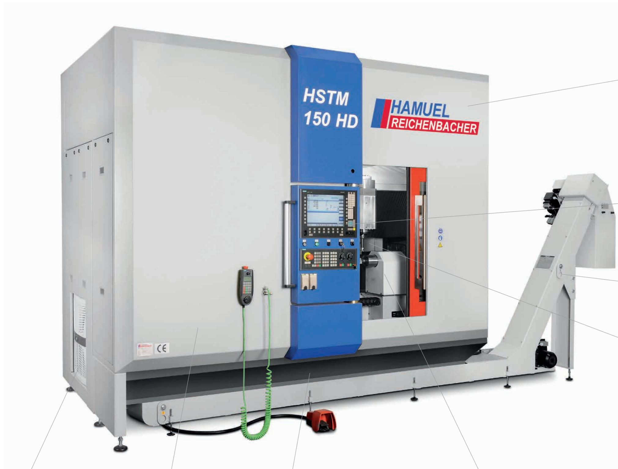
Die geschlossene Maschineneinhausung verbessert den Lärmschutz und verhindert, dass Späne den Maschinenraum verlassen. Im rückwärtigen Maschinenbereich ist der Zugang zu beweglichen Maschinenkomponenten durch eine Schutzverkleidung verhindert. Zur Wartung und zum Service können diese Verkleidungsteile einfach entfernt werden.
