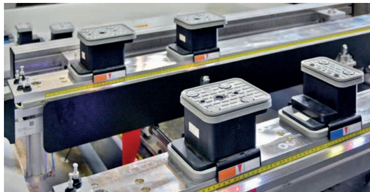
Am Maschinenbett und auf den einzelnen Trägern sind LED-Positionierstreifen angebracht, die die Position der Träger und der Sauger anzeigen.
