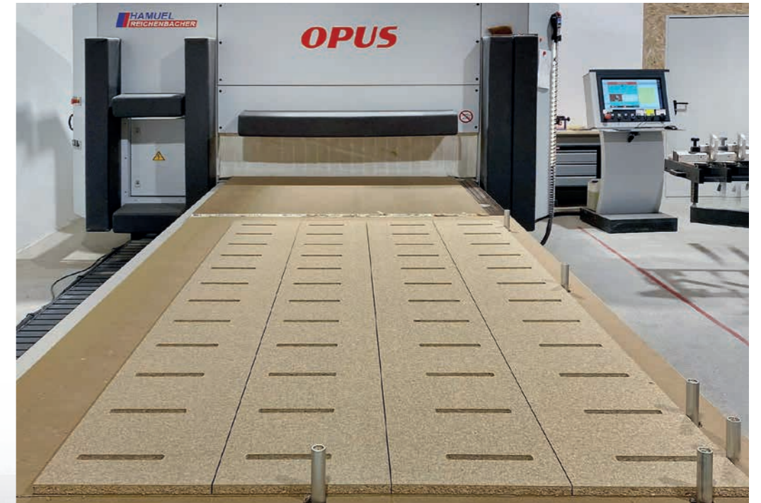
Tischgröße 5.200 x 1.450 mm, ausgerüstet für Arbeiten auf zwei Stationen mit 12 Einzelanschlügen.
