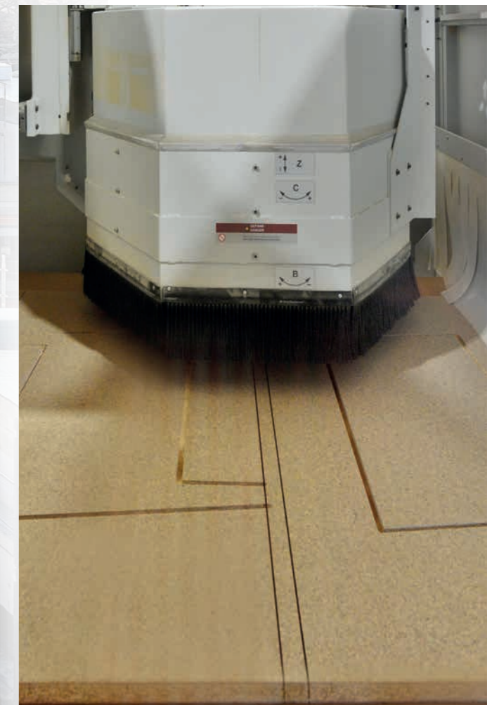
Zuschnitt von Kappenschalungen: Schablonen werden präzise und schnell aus den Platten gefräst.
