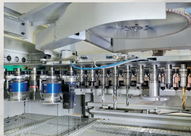
Der automatische Kettenwechsler für 61 Werkzeuge ist innerhalb der Portalkapselung hinter dem Arbeitsaggregat angebracht.
