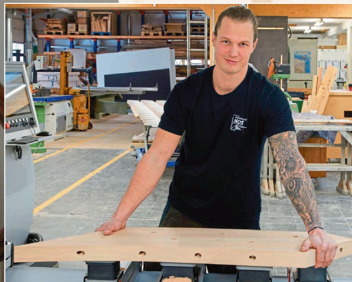
Diese Wange entstand in einer Aufspannung. Jetzt nur noch Kantenbrechen und leicht Schleifen.
