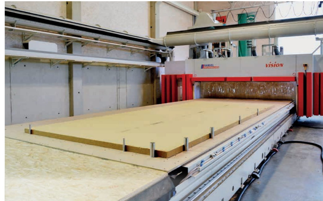
Bearbeitungstisch mit spezieller Tischverlängerung und Anschlägen.
