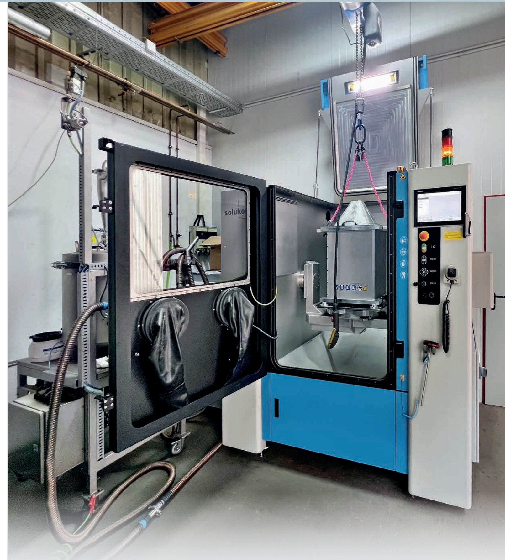
Die Baubox mit Bauteil und Pulver wird aus dem Reichenbacher-Drucker entnommen und in die Solukon-Anlage eingesetzt. Dort wird die Box zunächst als Ganzes über Kopf gedreht, bevor dann (nach Abnahme des Rahmens) die Feinreinigung ohne Box stattfindet.
