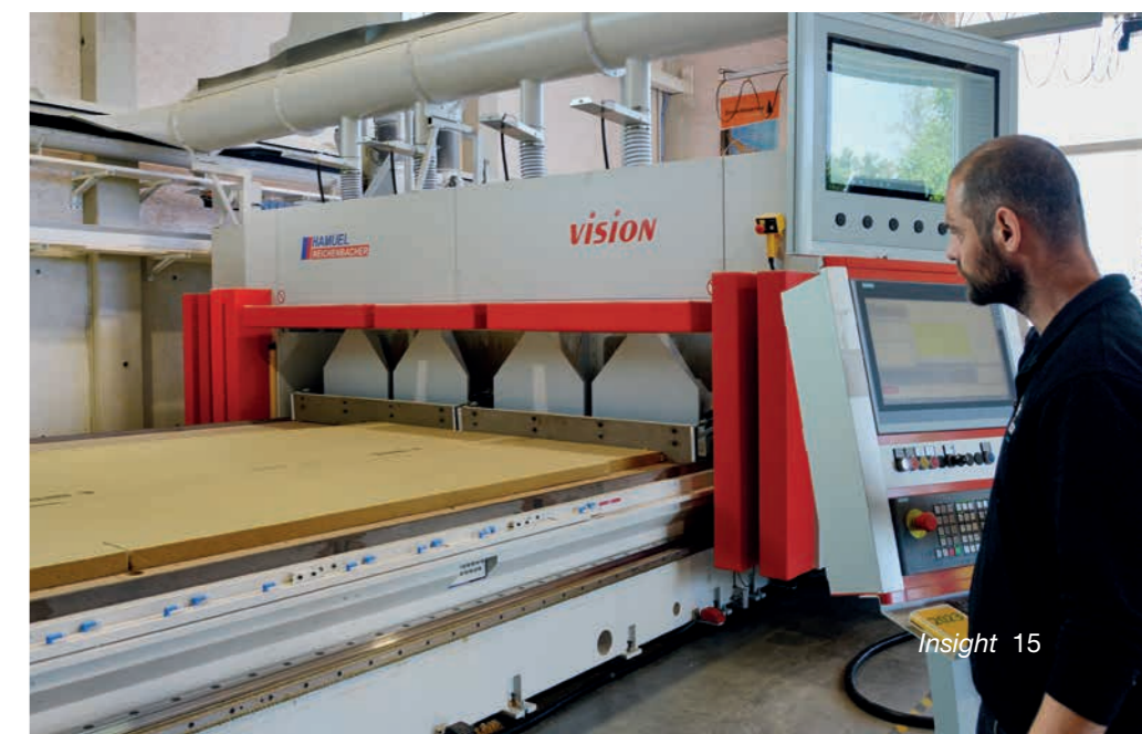
Lippenkanalabsaugung und Abschiebeeinheit, die es ermöglichen, Platten bis 14 Metern zu bearbeiten.
