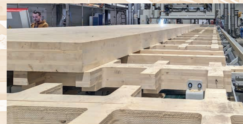
Ausgestattet mit einem Stahlträgertisch mit Holzauflagen und Fördertechnik können sehr große CLT-Platten bearbeitet werden.
