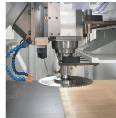
Der Synchronmotor erlaubt schnelles Sägen mit Sägeblattdurchmessern bis 450 mm.
