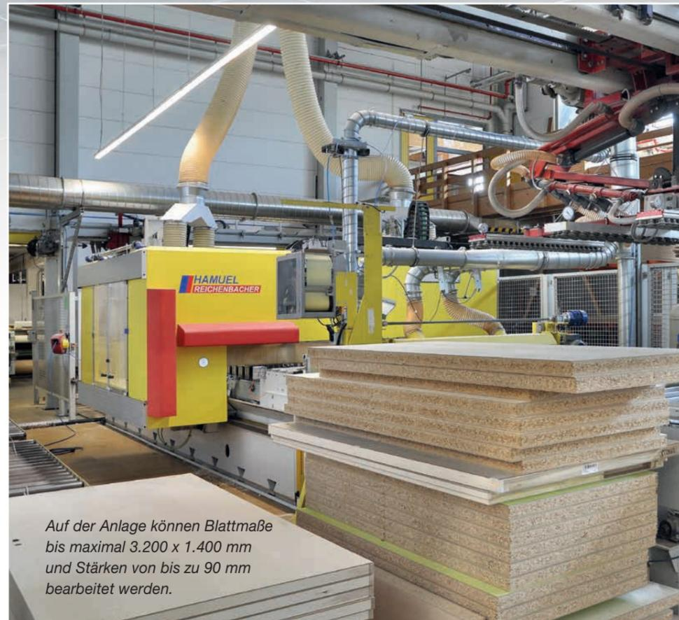
Auf der Anlage können Blattmaße bis maximal 3.200 x 1.400 mm und Stärken von bis zu 90 mm bearbeitet werden.
