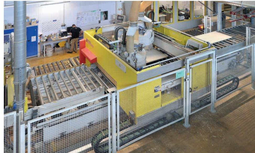
*Am U-förmigen Portal-aufbau sind zwei kardanisch gelagerte 5-Achs-Aggregate angebracht.*
