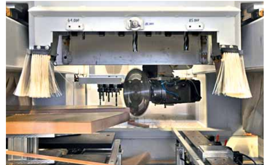
CNC-Bearbeitungszentrum „Vision-II-ST Sprint“ beim Formatieren der Treppenstufen mit dem 5-Achs-Arbeitsaggregat
