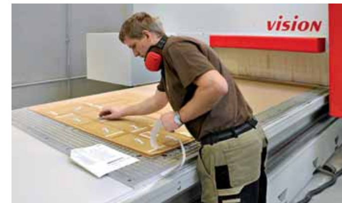
Der hohen Variabilität der Bauteile in Bezug auf Maße und Materialien musste man bei der Maschinenkonfiguration Rechnung tragen. Die Möglichkeit des Nestings in Wechselbeschickung wurde auf einer der drei CNC-Anlagen realisiert. Einzelteile werden nach dem Nesting von Hand mit Barcodes versehen
