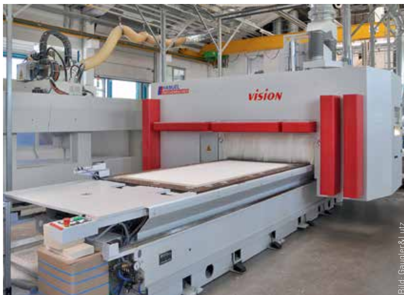
Eines dieser Produktionssysteme ist die Vision I Sprint, die zum neuesten Inventar gehört und eine von vier Reichenbacher-Anlagen vertritt, die den Anforderungen von Gaugler & Lutz entsprechen.
