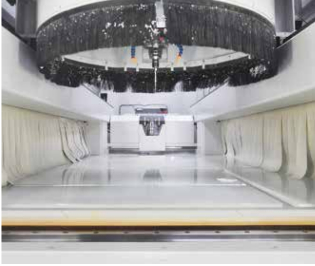
5-Achs Arbeitsaggregat mit vorlegbarer Absaughaube und mitfahrenden 24-fach Werkzeugwechslern.
