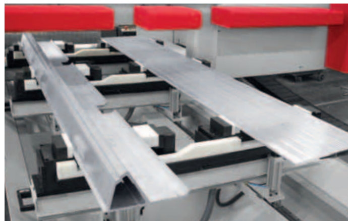
Pneumatische Horizontalspanner mit auswechselbaren Spannbacken zum Spannen von Aluminiumprofilen.
