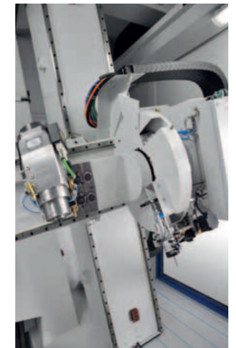
5-Achs-Arbeitsaggregat einer ECO-RS mit 12-fach Werkzeugwechsler an der C-Achse. Ein weiterer 6-fach Werkzeugwechsler befindet sich seitlich im Maschinenbett.
