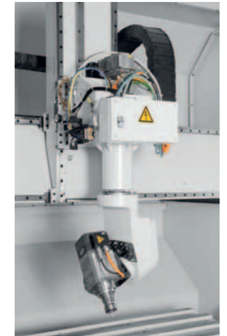
Kardanisch gelagertes 5-Achs-Arbeitsaggregat der ECO-LT, bis zu 46° unterschwenkend.
