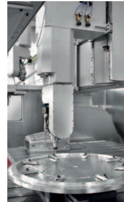
Bearbeitung eines Aluminiumrings für ein Flugzeugtriebwerk auf dem Bearbeitungszentrum ECO mit T-Nutentischen.
