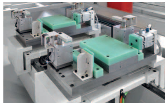
Pneumatische Spannvorrichtung in schwerer Ausführung mit Schwenkspannern und großer Kunststoffauflagefläche.
