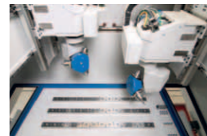
Kardanisch gelagerte Sternfräsköpfe (Aggregatevariante) der Schrägbettmaschine ECO-RS.
