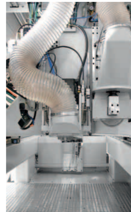
Arbeitsaggregat mit automatischem Werkzeugwechsel für vertikale Fräs-, Bohr-, Säge- und Schleifarbeiten sowie einem Sägeaggregat auf separatem Schlitten.
