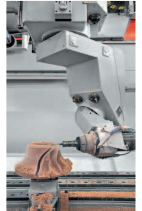
Bearbeitung eines Impellers aus Ureol (Cibatool) mit einem kardanischen 5-Achs-Arbeitskopf der ECO-NT.
