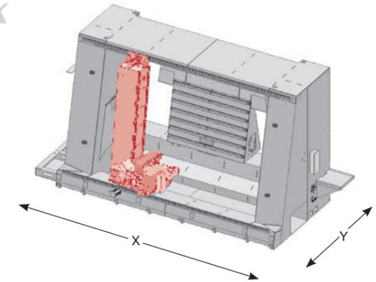
Bearbeitungszentren vom Typ **ECO-RS-1K** sind durch einen feststehenden, schwingungsarmen Portalrahmenbau mit integriertem Maschinentisch gekennzeichnet. Es ist ein Arbeitsaggregat installiert. Der Maschinentisch steht nahezu senkrecht (um 12° schräggestellt) und kann zum Beschicken um 180° gedreht werden. Die Beschickung erfolgt von der Vorderseite. Der Bediener ist geschützt vor Staub und Lärm. Alle Aggregatbewegungen verlaufen innerhalb der Schutzkabine.
