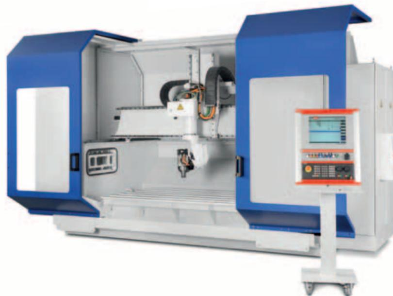
Schon der Basistyp der ECO-LT bietet als Einstiegsmodell ein hohes Maß an Produktivität. Für die Bearbeitung vieler Werkstückformen und Materialien ist diese etwas leichter konstruierte Maschine bestens geeignet. Der Beschickungsraum der **ECO-LT 2212** wird durch zwei Schiebetore verschlossen. Die Fronttüren lassen sich manuell öffnen und schließen. Die speziell entwickelten 5-Achs-Fräsköpfe sind aufgrund ihrer Geometrie auch für die Bearbeitung schwer zugänglicher Werkstückstellen ausgelegt.
