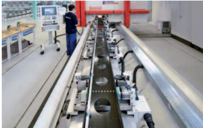
Bearbeitungszentrum UNIVERS mit eingespanntem I-Profilträger für den Flugzeugbodenbau.
