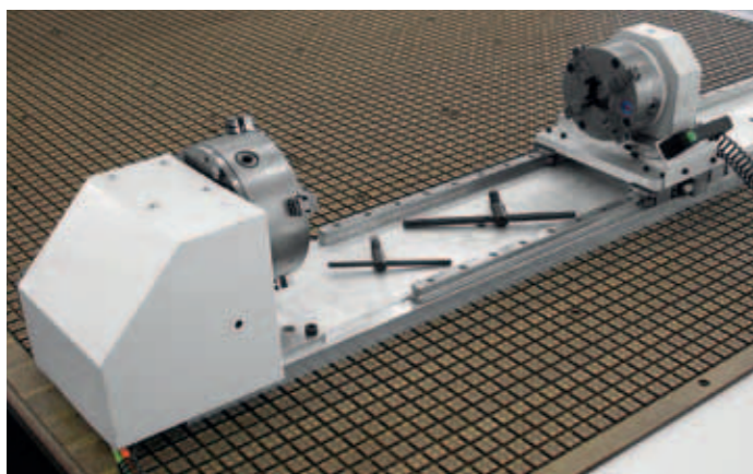
Kleine NC-Drehachse (bis Ø 310 mm) auf Vakuumrastertisch.
