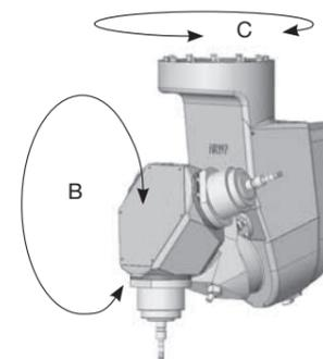
**5-Achs-Sternfräskopf** mit kardanisch gelagerter 3-fach Frässpindelrevolver. Die Spindeln sind sternförmig, im Winkel von 120° zueinander, angeordnet. Der Spindel- bzw. Werkzeugwechsel erfolgt durch die Weitertaktung des Spindelrevolvers. Die Arretierung erfolgt über eine mechanische Verriegelung.
