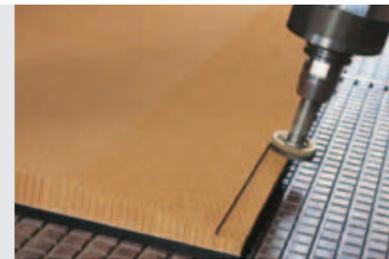
Wabenkernbearbeitung, zum Beispiel zur Versteifung von Flugzeugflügeln.
