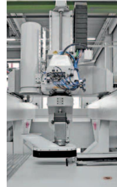
Einwechselbare Absaughaube für einen 5-Achs-Arbeitskopf zur 3-Achs-Bearbeitung.
