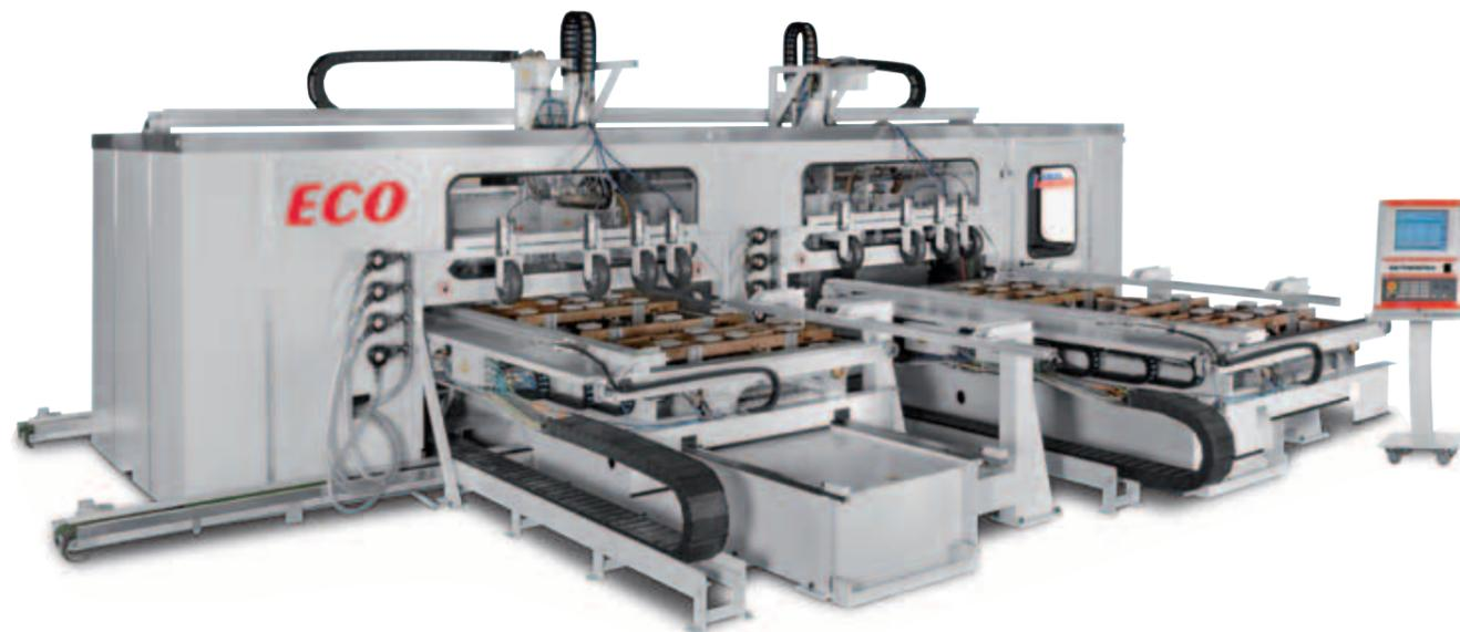
Ein Koordinatentisch, ein programmierbarer Trägertisch mit schnellrüstbaren Spannvorrichtungen, oder ein selbstrüstender Pintisch, ermöglichen es, die Produktion auftragsbezogener Werkstücke der Losgröße 1 mit den Anforderungen an eine serielle Fertigung zu verwirklichen. Die ECO ist keine Maschine von der Stange. Ihre Anregungen und Wünsche fließen in die Planung und in das sorgfältig erarbeitete Angebot ein.
