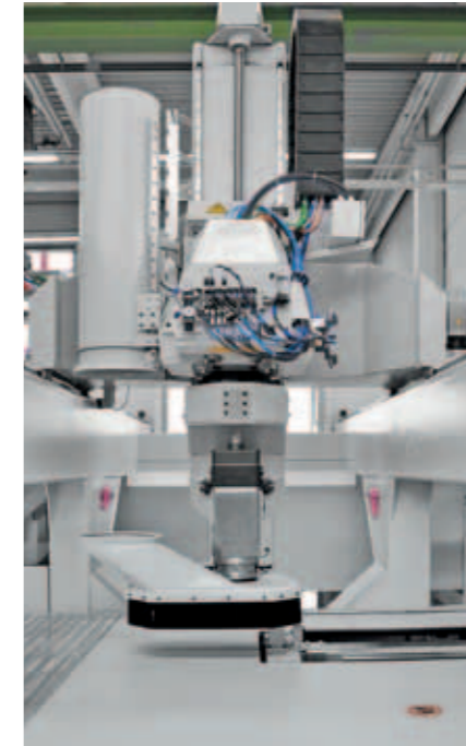
Einwechselbare Absaughaube für einen 5-Achs-Arbeitskopf zur 3-Achs-Bearbeitung.
