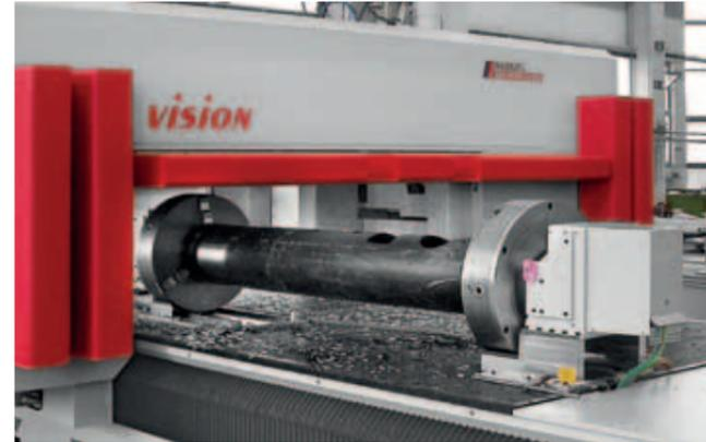
Rohrleitungsbearbeitung auf zusätzlicher NC-Drehachse (bis Ø 600 mm).
