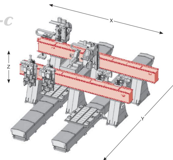
Der Maschinentyp **ECO-C** ist durch ein feststehendes, schwingungsarmes 3-Ständer-Portal mit zwei fahrbaren Bearbeitungstischen gekennzeichnet. Die Tische sind je zwischen dem linken und mittleren bzw. mittleren und rechten Portalständer angeordnet. Mit zwei Aggregaten ist, durch den großen Tischabstand, eine völlig unabhängige Bearbeitung auf den beiden Maschinenhälften möglich.
