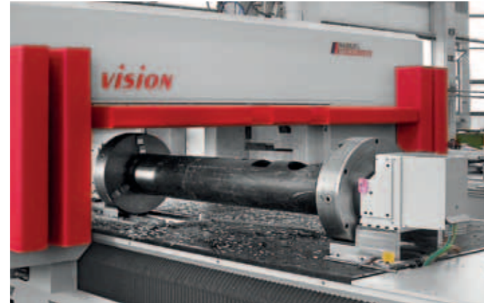
Rohrleitungsbearbeitung auf zusätzlicher NC-Drehachse (bis Ø 600 mm).
