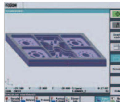
Für das CNC-Fräsen von Einzelteilen und Kleinserien ist eine ebenso einfache wie effiziente Programmierlösung gefragt. ShopMill bietet eine werkstattgerechte Bedien- und Programmieroberfläche für das CNC-Fräsen – ausgelegt auf die einfache Bedienung der Maschine und die leichte Programmierung von Werkstücken.
