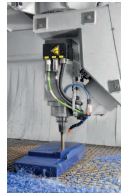
Zerspaltung eines Kunststoffteils (Keil) für die Getränkeabfüllung mit der VISION-I-H, kardanischer 5-Achs-Arbeitskopf, Z-Hub 780 mm.
