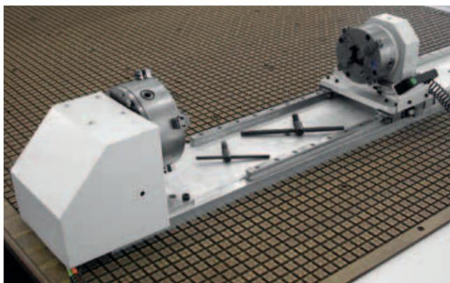
Kleine NC-Drehachse (bis Ø 310 mm) auf Vakuumrastertisch.
