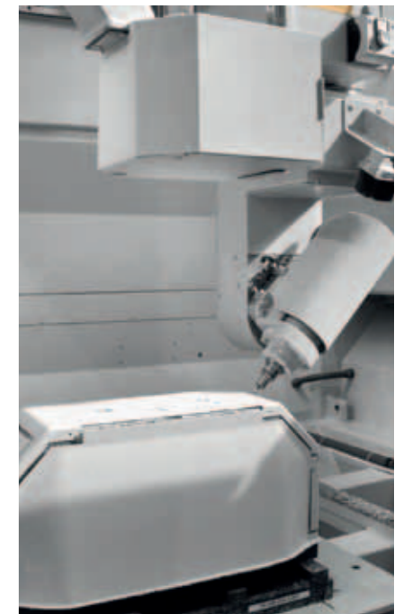
Fräsen eines Kunststoffformteils mit der ECO-NT, 5-Achs-Gabel-Arbeitskopf, Z-Hub 1.000 mm.
