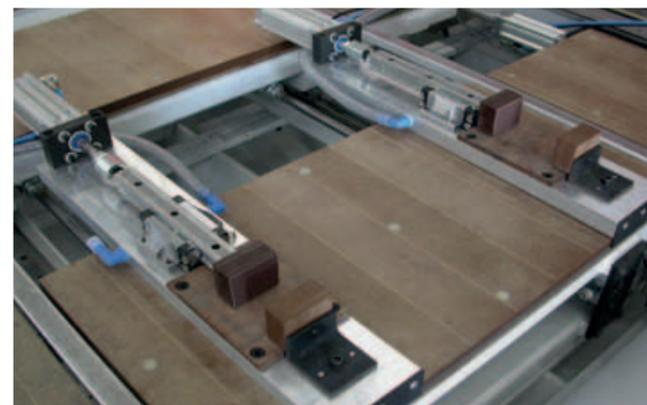
Pneumatische Spannvorrichtung zur Profilbearbeitung.
