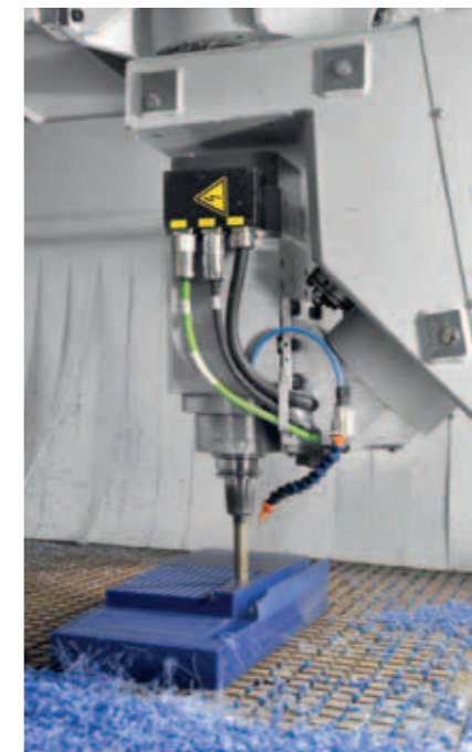
Zerspanung eines Kunststoffteils (Keil) für die Getränkeabfüllung mit der VISION-I-H, kardanischer 5-Achs-Arbeitskopf, Z-Hub 780 mm.
