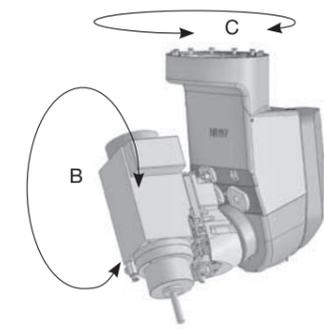
**5-Achs-Fräskopf** mit kardanisch gelagerter Frässpindel. Der Schwenkblock inkl. Spindel ist an einer 68° Schräge angebracht, somit ist eine unterschwenkende Bearbeitung von bis zu 46° möglich. Optional lässt sich oberhalb des Fräskopfes ein mitfahrender Werkzeugwechsler installieren.
