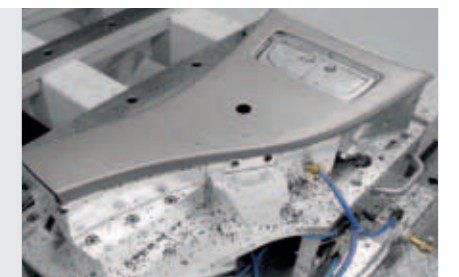
Spannvorrichtung mit Interieur-Bauteil auf einer ECO-NT.
