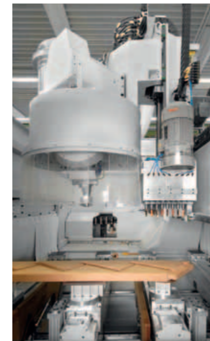
ARTIS-X mit automatischem Rüsttisch, 25-fach Mehrspindelbohraggregat und 36-fach Ketten-Werkzeugmagazin.
