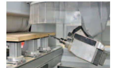
Kardanisches 5-Achs-Arbeitsaggregat (Spindel 24 kW, unterschwenkend -20°) zur Bearbeitung von Massivholz.
