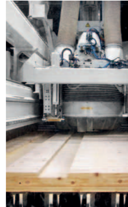
VISION-III-TT zur Bearbeitung von Holzhauswänden bis zu einer Größe von 13.500 x 3.200 x 250 mm.
