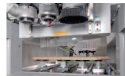
3x vorlegbare Fräsmotoren vorne am Y-Schlitten montiert und mit dem kardanischen Arbeitskopf verbunden.
