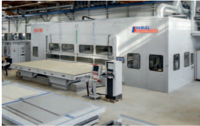
Bearbeitungszentrum vom Typ ECO mit koppelbaren Tischen zur Bearbeitung von Plattengrößen bis zu 3,3 x 7,0 m.
