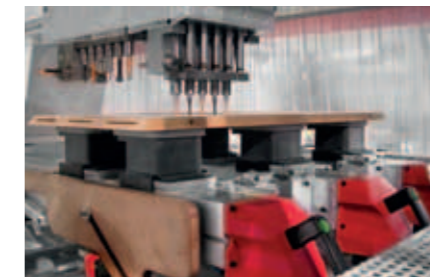
Bearbeitung eines Korpusteils mit dem 15-fach Bohraggregat einer ARTIS.
