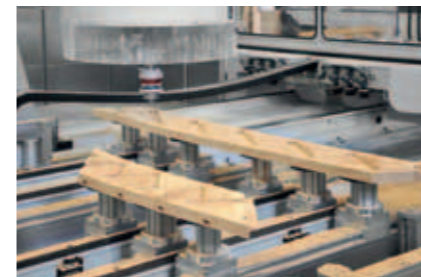
Bearbeitung von Treppenwangen auf einer ECO mit 2 automatischen Rüsttischen.
