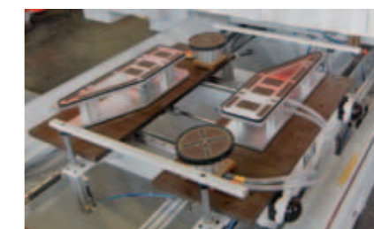
Stufenspannvorrichtung links und rechts für wechselseitiges Bearbeiten. Saugerausführung: Zentralsauger, dadurch kein Vorrichtungswchsel nötig.
