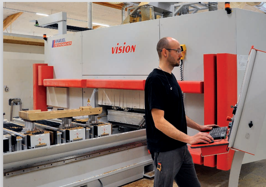
Maschinenbediener Peter Köppli am Reichenbacher CNC-Bearbeitungszentrum VISION-II Sprint bei der Anpassung des CNC-Programms.
