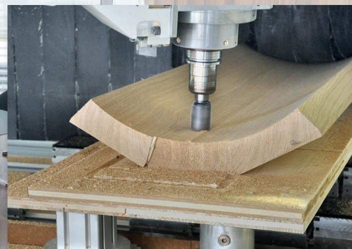
5-Achs-Bearbeitung eines Kropfpfostens.
