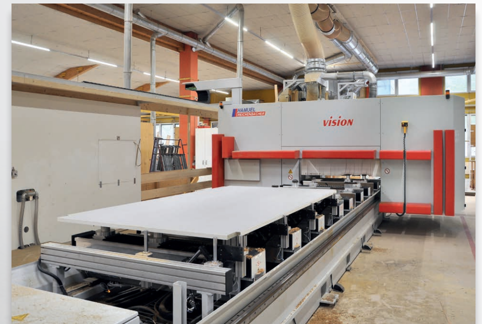
CNC-Bearbeitungszentrum VISION-II Sprint in Anschlagposition mit fertig bearbeitetem Werkstück.
