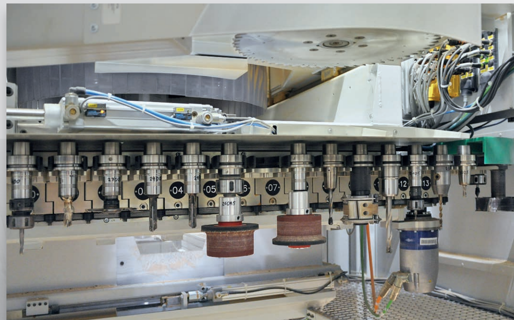
Automatischer Kettenwechsler für 40 Werkzeuge mit Pick-Up Platz für eine Säge bis max. Ø 450 mm.
