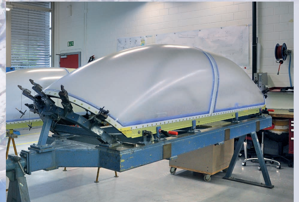
Endmontage Cockpithauben für Trainingsflugzeuge.
