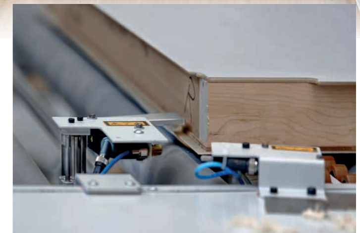
Pneumatisch vorlegbares Anschlaglineal, ausgelegt für einen maximalen Furnierüberstand von 1 - 50 mm.
