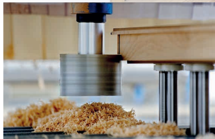
Türen-Bearbeitung: Flexibilität bei Sonderfalztüren, Fräsen in allen Ebenen durch freiliegende Türen.
