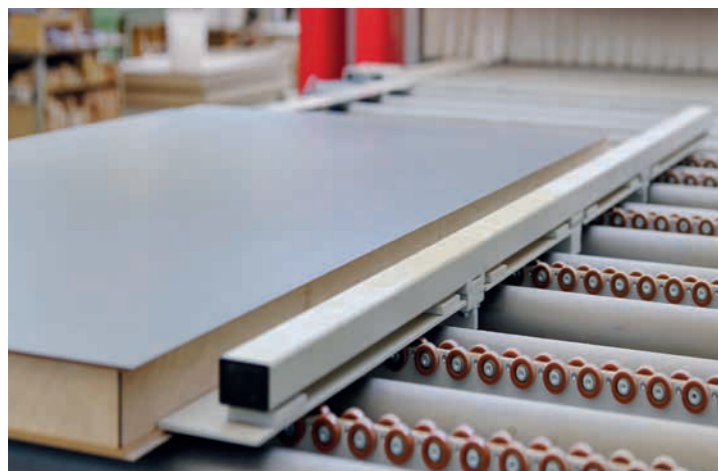
Ausrichteinrichtung mit pneumatischem Aushub einer Mehrfach-Rollenleiste zum Querausrichten der Werkstücke in Y-Richtung.
