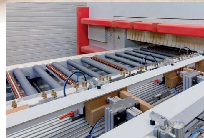
Das CNC-Bearbeitungszentrum ist eine Durchlaufanlage, ausgestattet mit Rollenbahnen.
