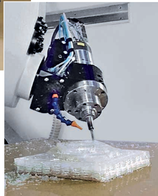
Der kardanisch gelagerte 5-Achs-Arbeitskopf ermöglicht die hochpräzise räumliche Bearbeitung von Freiflächen und Konturen während und nach dem 3D-Druck.
