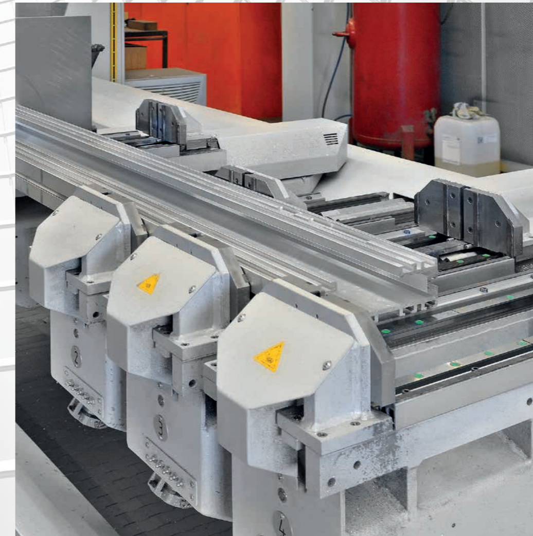
Exakt auf die Bauteile abgestimmte Spannbacken oder Niederhalter sind wichtig für hochgenaue Fräsergebnisse.
