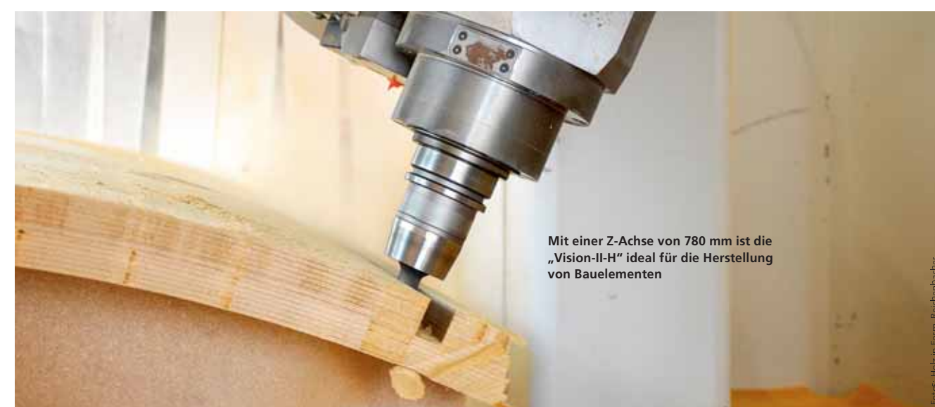
Groß, rund und komplex zu bearbeiten: 2,5 Meter hohe Bauteile für einen Lichtschacht
