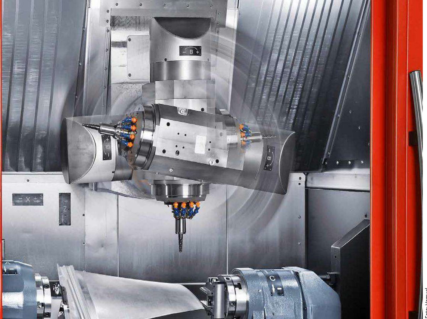
Extreme Schwenkbewegungen der B-Achse beim Fertigen von Turbinenschaufeln.
