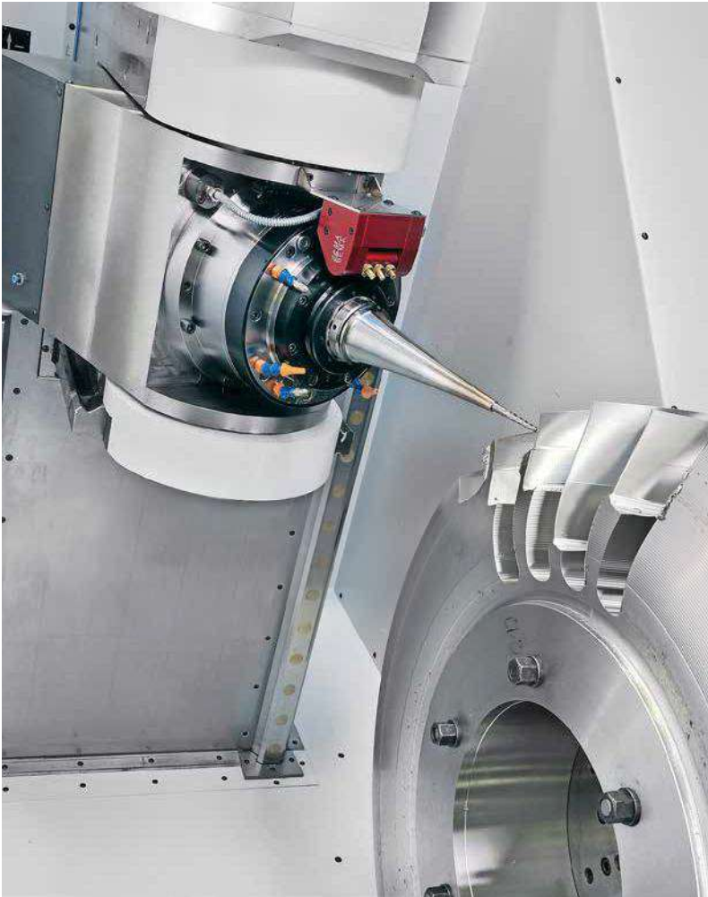
Bearbeiten von einem Blisk auf dem 5-Achs-Bearbeitungszentrum HSTM 1500 XL von Hamuel.
