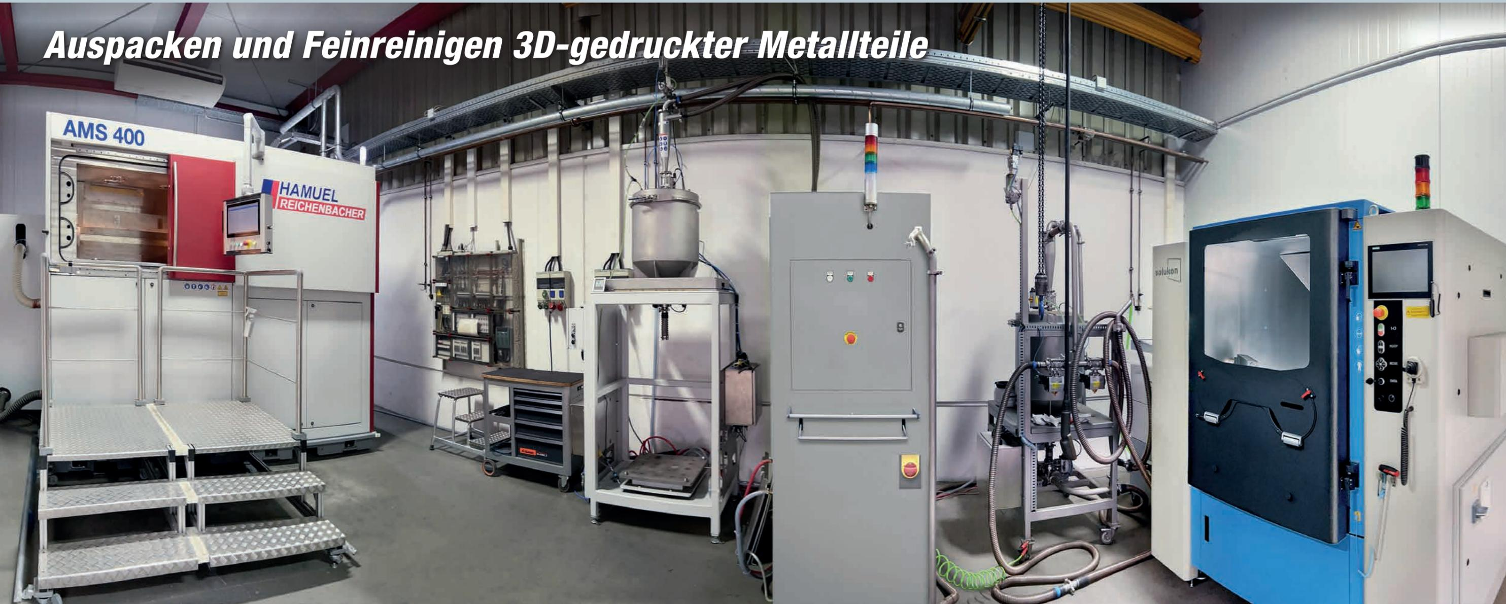
*Kooperation von Reichenbacher und Solukon verbindet essenzielle Postprocessing-Schritte und ermöglicht erstmals automatisiertes Boxentpacken.*
