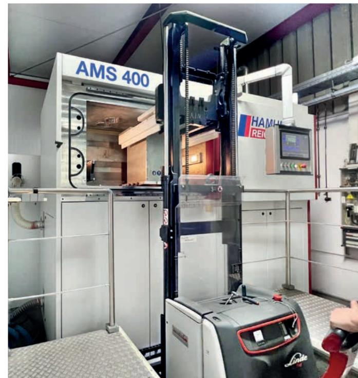
*Der 3D-Drucker AMS 400 von Reichenbacher und das Entpulverungssystem SFM-AT1000-S von Solukon für automatisiertes Auspacken und Feinreinigen von 3D-gedruckten Metallteilen.*
